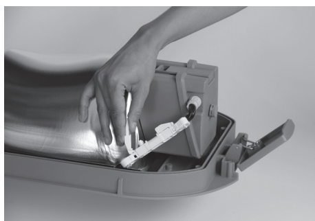
4 Liberación del seguro del conector
